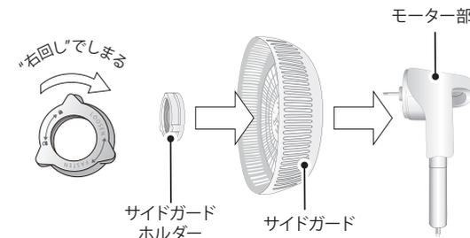
サイドガードの穴とモーター部の突起の位置 (図○部分3か所) を図を参考に合わせて装着してください。
