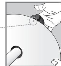
正しくドックに接続されると、「ピッ」という電子音が鳴り、ディスプレイの電源マークが赤点灯し、バッテリーマークが赤点滅して充電を開始します。充電完了後はバッテリーマークが青点灯に切り替わります。
