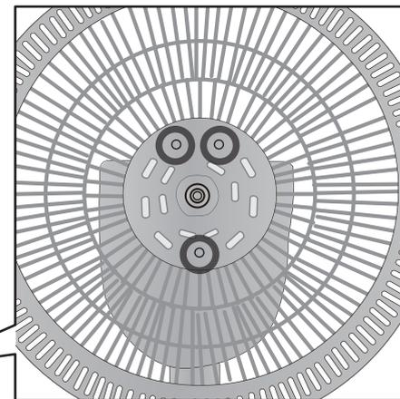
**2** ①で組み立てたモーターのシャフトにファンを挿し込みファンホルダーでファンを固定する。
