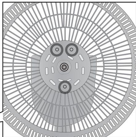
**2** ①で組み立てたモーターのシャフトにファンを挿し込み
