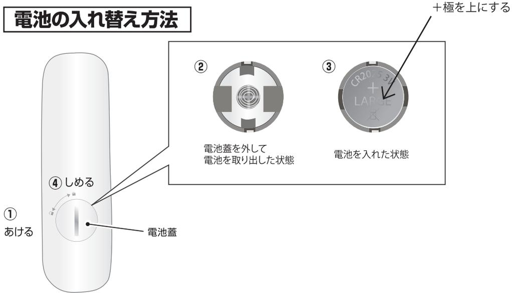
① マイナスドライバーなどをリモコン裏の電池蓋の溝に合わせて、反時計回りにまわします。
